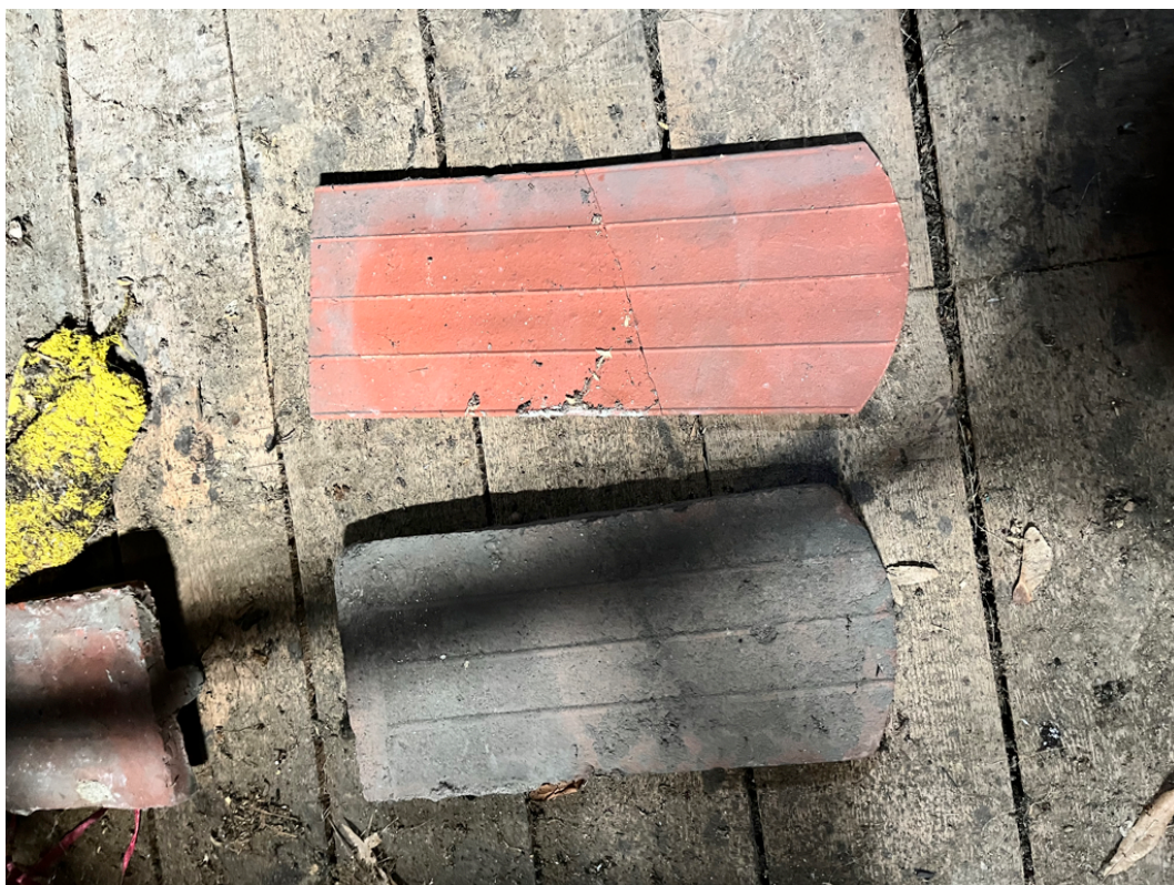
Fot. 7. Na zdjęciu w poniżej dachówka pierwotna, powyżej dachówka obecnie pokrywająca konstrukcję dachu.
